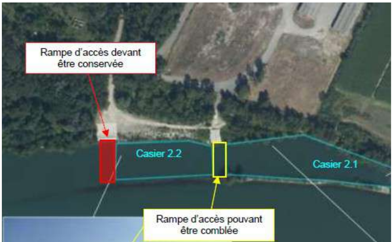
Découpage du casier 2 en deux zones et remise en état des rampes d'accès
